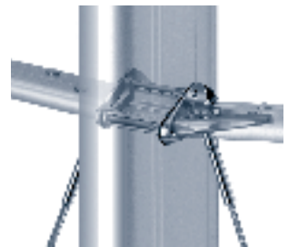
Genomgående spridarfäste med integrerade fästen för undervant eller mellanvant.
